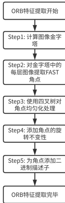
Figure 2.2: ORB-SLAM 图像特征提取流程
